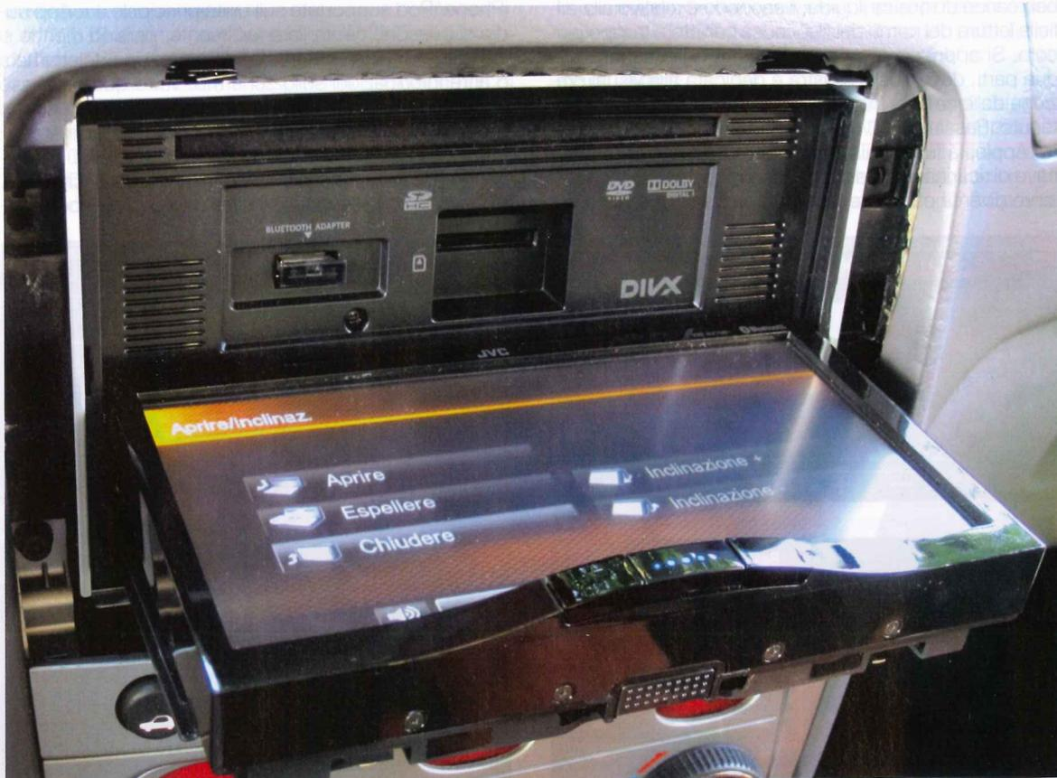
L'inserimento del CD/DVD avviene tramite il ribaltamento completo del frontale; si nota la scheda Bluetooth inserita in fabbrica e lo slot per la scheda SD.
